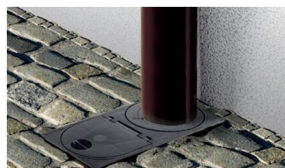
26. При монтаже непосредственно в систему ливневой канализации, на нижнюю часть водосточной трубы устанавливается ревизия с решеткой внутри для сбора загрязнений. Прежде чем вновь закрыть ревизию диаметром 110 мм, необходимо смазать уплотнитель. Соединение между водосточной трубой диаметром 75 мм и 90 мм и трубой канализации диаметром 110 мм выполняется при помощи перехода.
